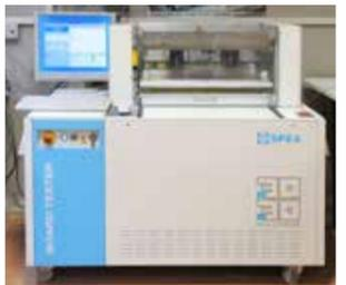
Test in-circuit parametrico (fixture)
