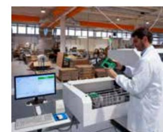
Test in-circuit parametrico (fixture)
