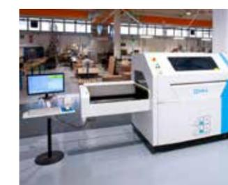
Test in-circuit parametrico (Flying Probe)
