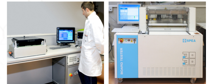
Funktionsprüfung Multi-Applikations In-Circuit-Test-Parameter (Vorrichtung)
