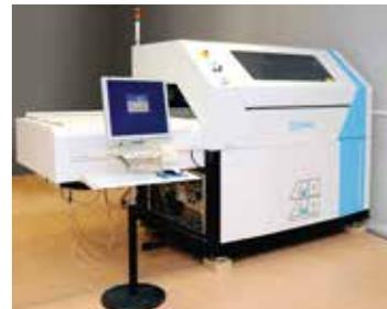
Test in-circuit parametrico (Flyprobe)
