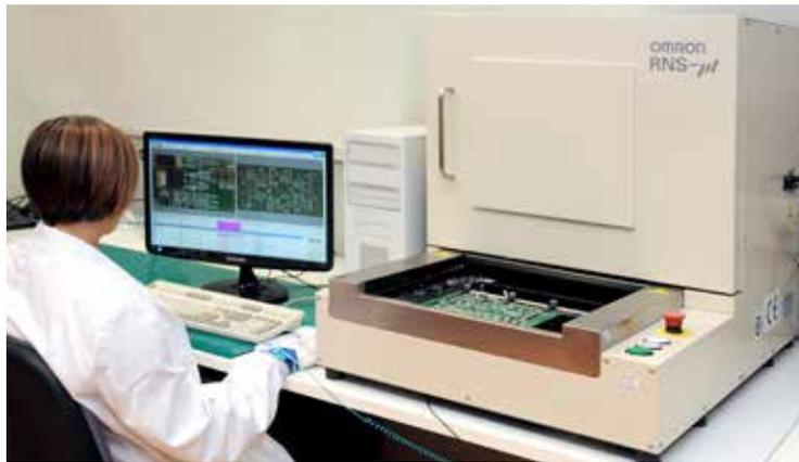
Dopo il processo di assemblaggio smt e Pht tutte le schede vengono sottoposte ad ispezione ottica automatica al fine di prevenire ed individuare eventuali difetti di montaggio o di saldatura.
