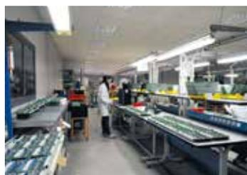
Il montaggio di componentistica PTH ( Pin Through Hole) è divenuto nel tempo decisamente meno richiesto a favore della componentistica SMD. Ovviamente i nostri progettisti tendono ad impiegarlo solo dove strettamente necessario, vuoi per problemi meccanici vuoi perché non esiste l'analogo componente a montaggio superficiale.
