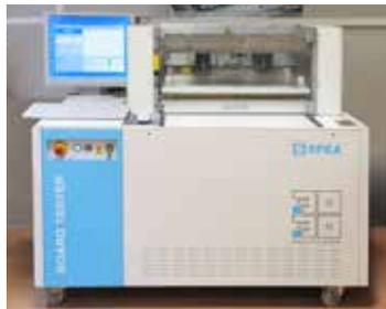
Test in-circuit parametrico (fixture)
